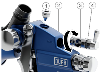
Obr. 17: Výměna O kroužku na regulaci vzduchu
